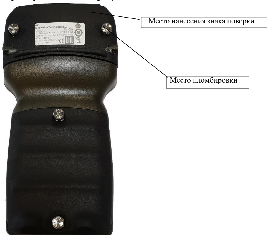
Рисунок 2 – Схема пломбировки от несанкционированного доступа
