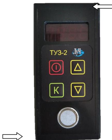
Рисунок 1в - общий вид толщиномеров ультразвуковых ТУЗ-2 в пластиковом корпусе и места пломбирования
