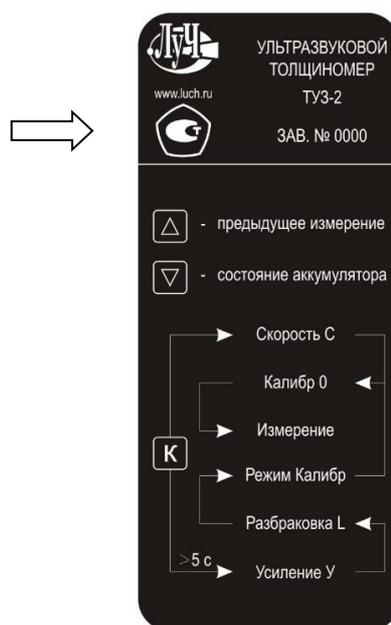
Рисунок 2б – Общий вид задней панели толщиномеров ультразвуковых ТУЗ-2 в металлическом и пластиковом корпусе (исполнение 1б и 1в) и место нанесения знака утверждения типа
