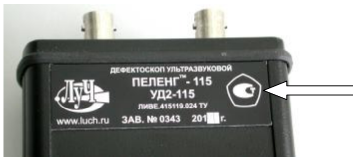
Рисунок 2 – Шильд задней панели и место нанесения клейма.
