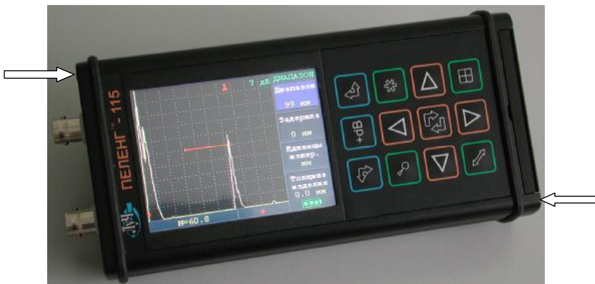
Рисунок 1 - Общий вид дефектоскопов «ПЕЛЕНГ-115» (УД2-115) и места нанесения пломбировки.
