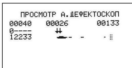
Рисунок 45 - Просмотр результатов УЗК с расшифровкой для толщин 4÷9 мм.
