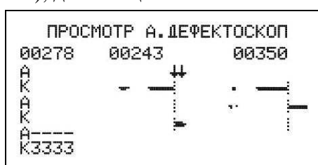
Рисунок 46 - Просмотр результатов УЗК с расшифровкой для толщин 10 мм и более.
