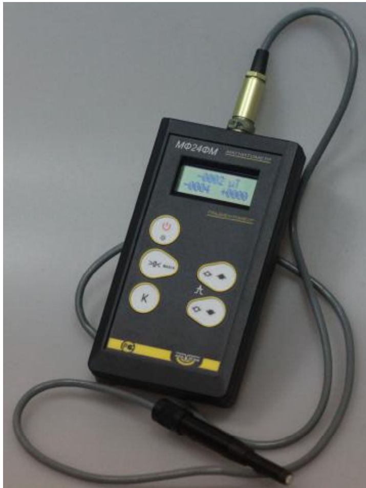
Рисунок 1 – Фотография общего вида магнитометра исполнения МФ-24ФМ и схема пломбировки от несанкционированного доступа
