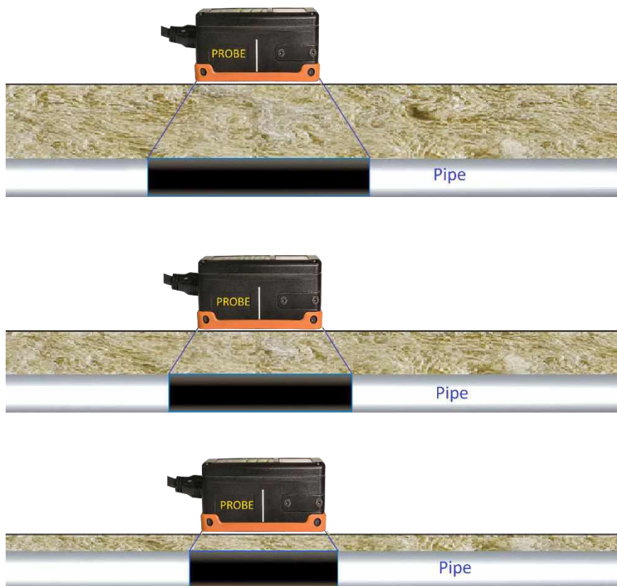
Рисунок 44. Зависимость размера области намагничивания от толщины изоляции.
