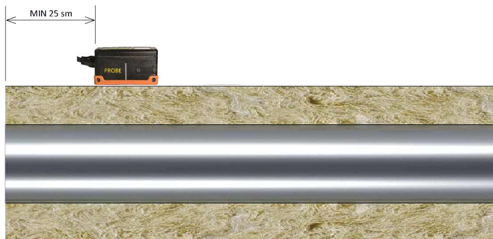
Рисунок 45. Датчик располагать не ближе, чем 25 см от торца трубы.
