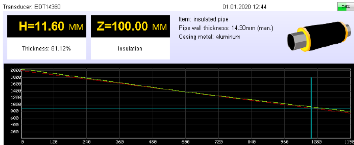
Рисунок 46. Пример внешнего вида А-скана.
