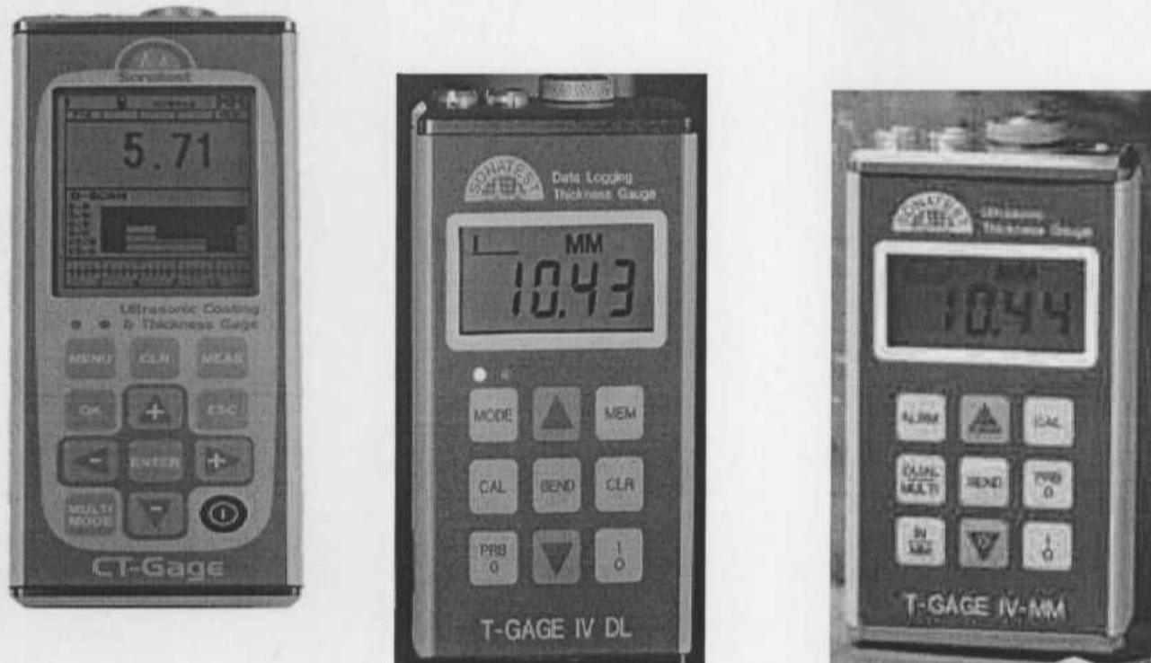
Рисунок1. Внешний вид толщиномеров
