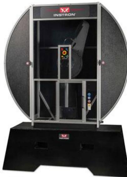
Рисунок 1 - Общий вид копров маятниковых серии MPX
