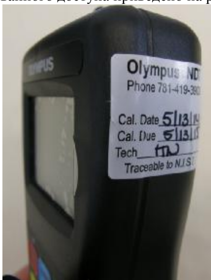
Рисунок 2 - Схема пломбировки от несанкционированного доступа
