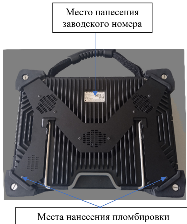
Рисунок 2 – Схема пломбировки от несанкционированного доступа и место нанесения заводского номера
