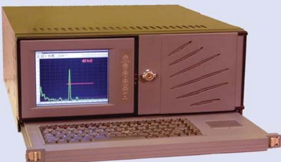
Стационарный, многоканальный дефектоскоп ИНТРОТЕСТ-2 предназначен для обнаружения дефектов типа несплошностей в различных материалах, изделиях и сварных соединениях. Дефектоскоп позволяет измерять координаты дефектов и толщину стенки. Работает в составе механизированных и автоматизированных установок.
