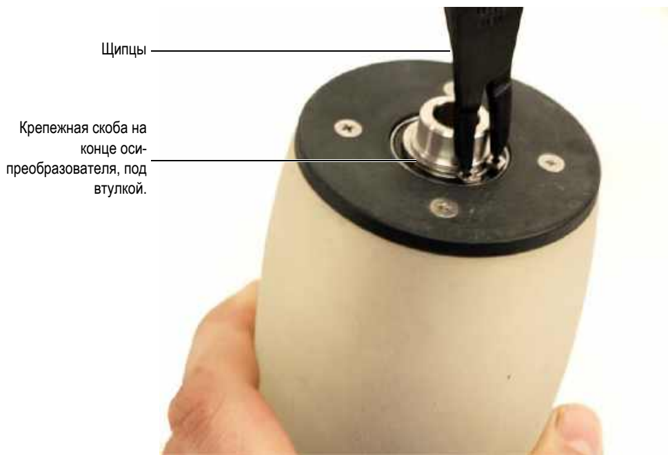
Рис. 6-7 Снятие крепежной скобы с наконечника оси-преобразователя
