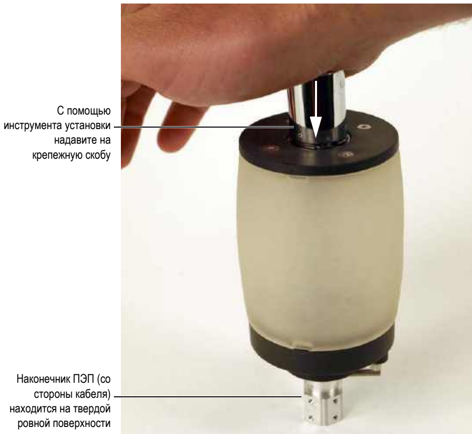
Рис. 6-11 Установка крепежной скобы на наконечник оси-преобразователя
