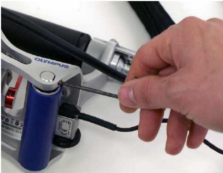
Рис. 6-40 Ослабление крепежного винта заднего ролика
