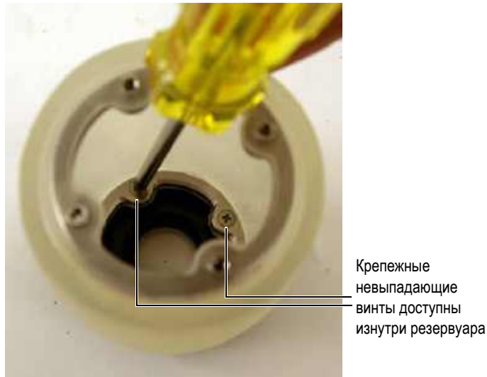
Рис. 6-32 Затяжение крепежных винтов фланца (с контрольными клапанами) изнутри резервуара
