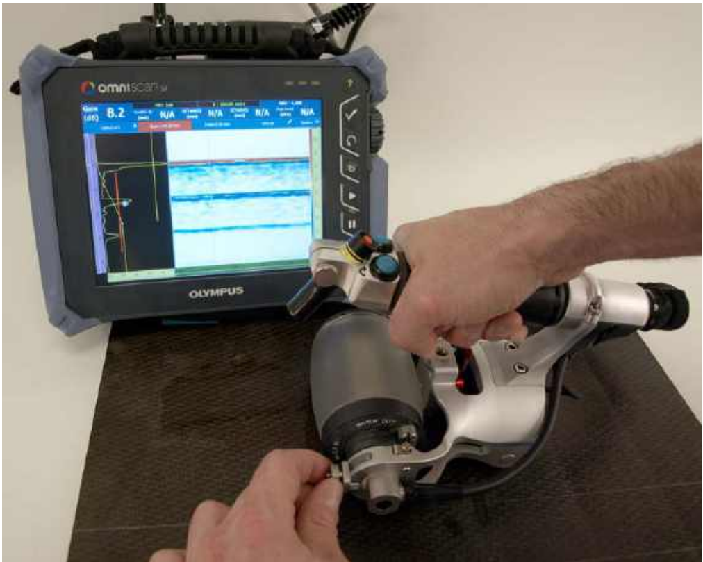
Рис. 4-1 Настройка угла преобразователя для оптимизации сигнала
