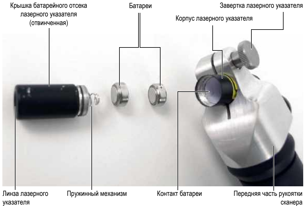
Рис. 6-61 Замена батарей лазерного указателя
