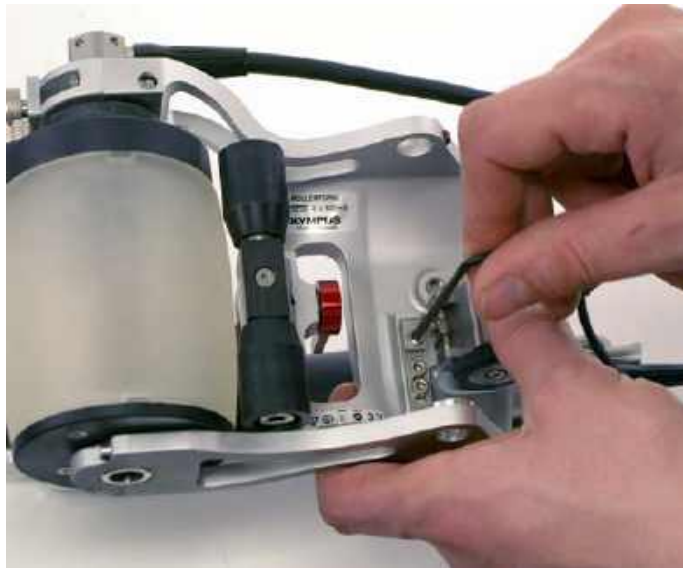
Рис. 6-55 Ослабление крепежного винта кодировщика
