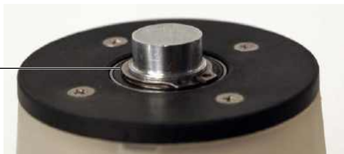
Рис. 6-12 Установка крепежной скобы на наконечник оси-преобразователя
