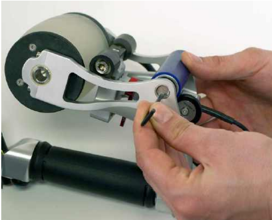
Рис. 6-53 Извлечение оси заднего ролика из гнезда
