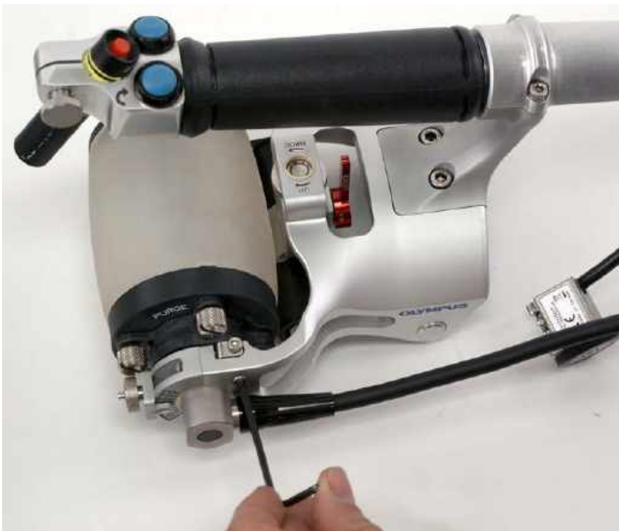
Рис. 6-58 Ослабление винта альтернативного держателя кодировщика
