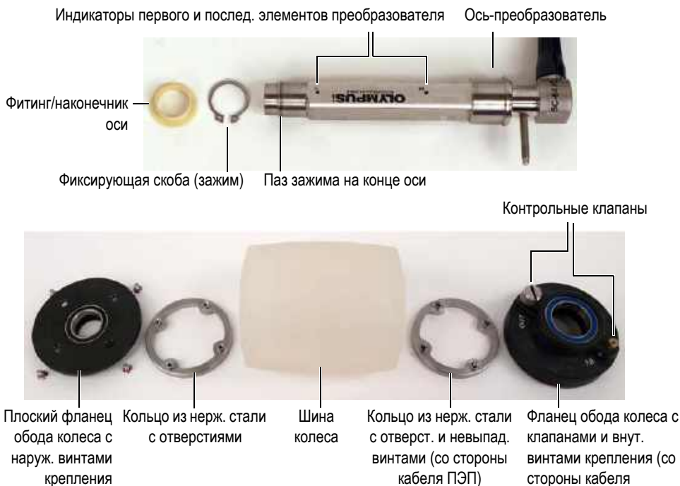
Рис. 1-3 Компоненты акустического колеса
