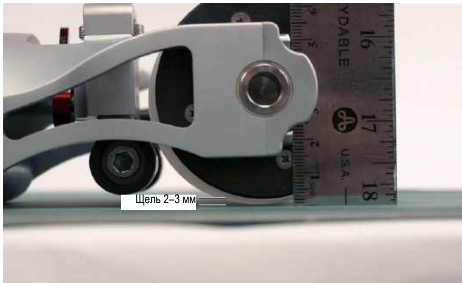
Рис. 3-5 Измерение ширины щели между фланцем акустического колеса и поверхностью
