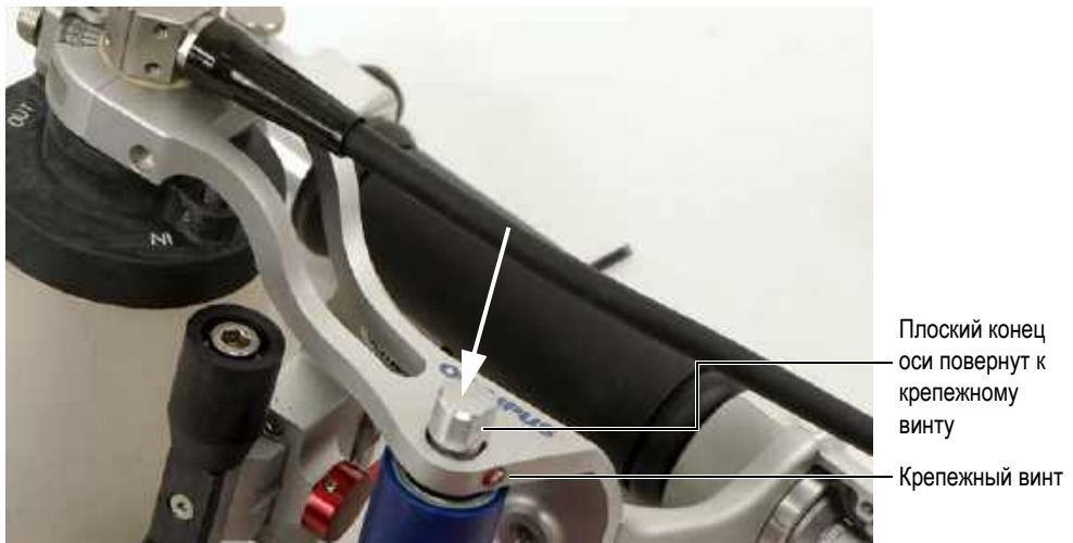
Рис. 6-49 Выравнивание плоской части оси ролика с крепежным винтом
