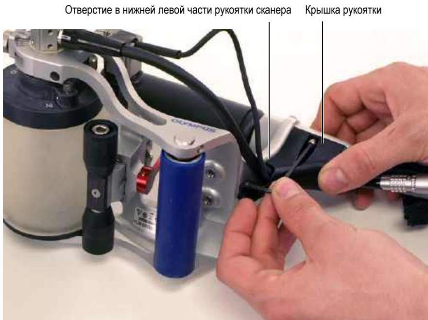
Рис. 6-50 Установка крышки на рукоятке сканера RollerFORM
