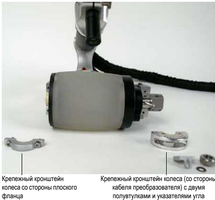
Рис. 6-2 Демонтаж крепежных кронштейнов акустического колеса
