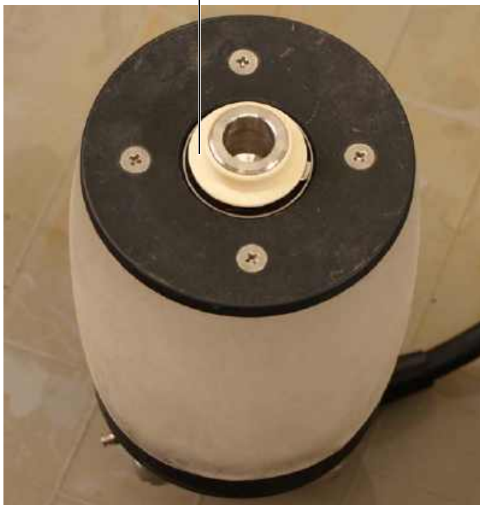
Рис. 6-35 Установка втулки на конце оси-преобразователя
