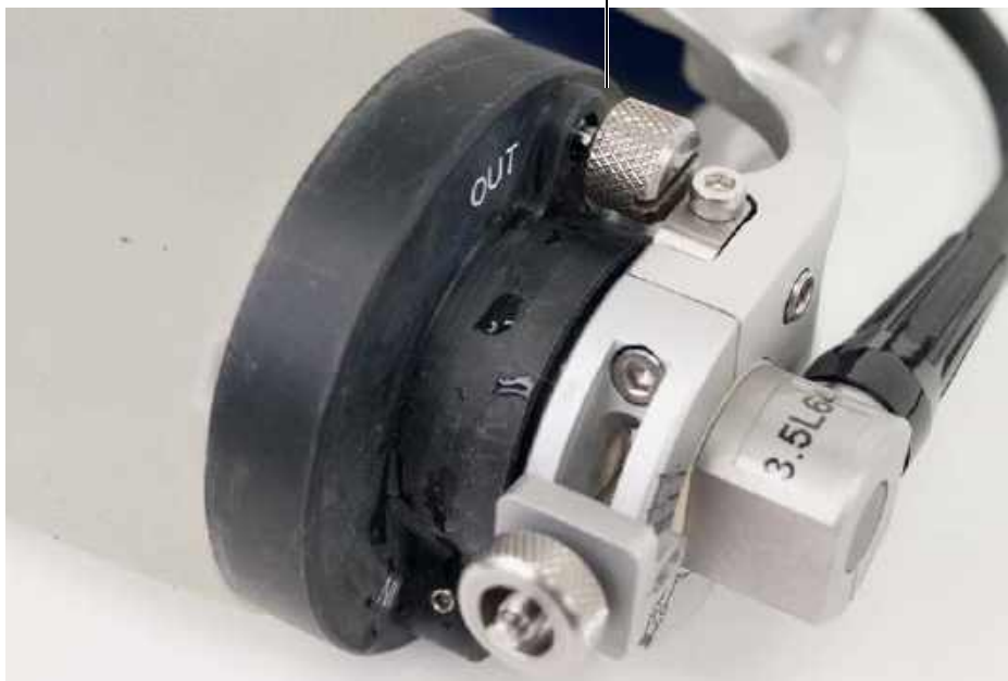
Рис. 3-1 Открытый клапан OUT на фланце
