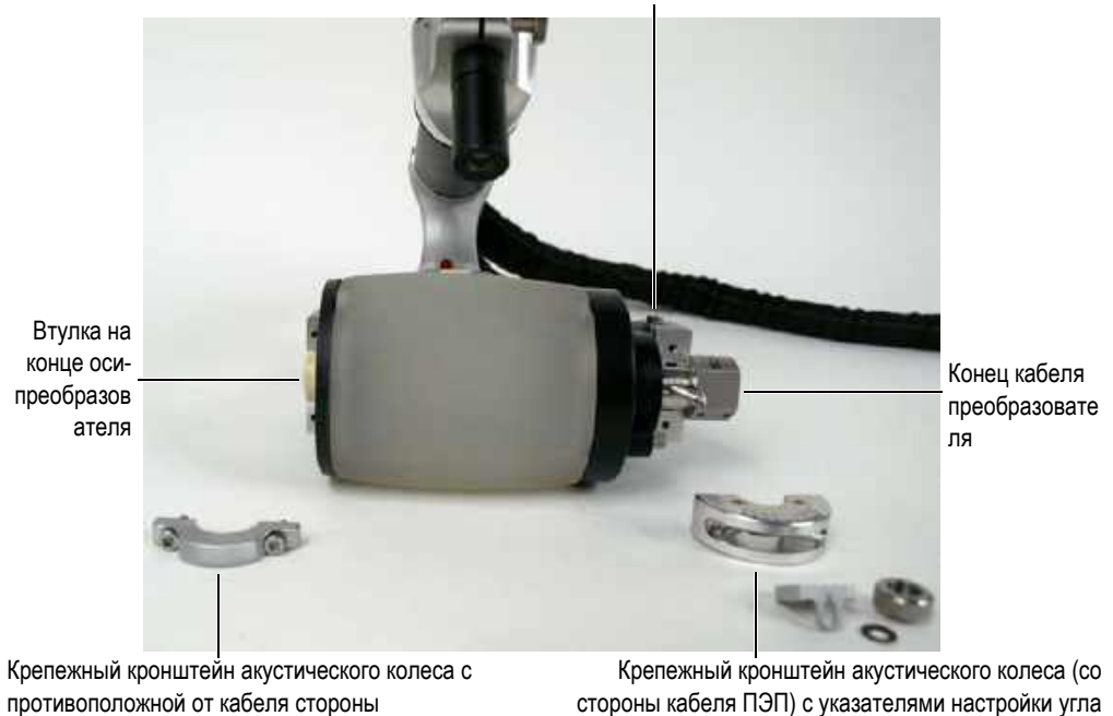
Рис. 6-36 Установка крепежных кронштейнов акустического колеса
