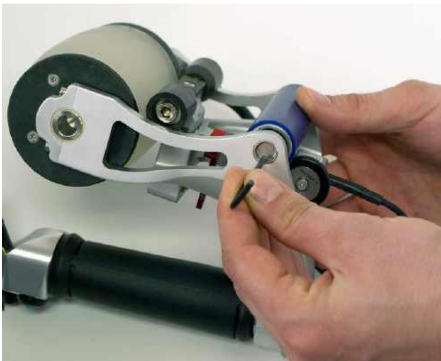
Рис. 6-41 Выталкивание оси заднего ролика из гнезда
