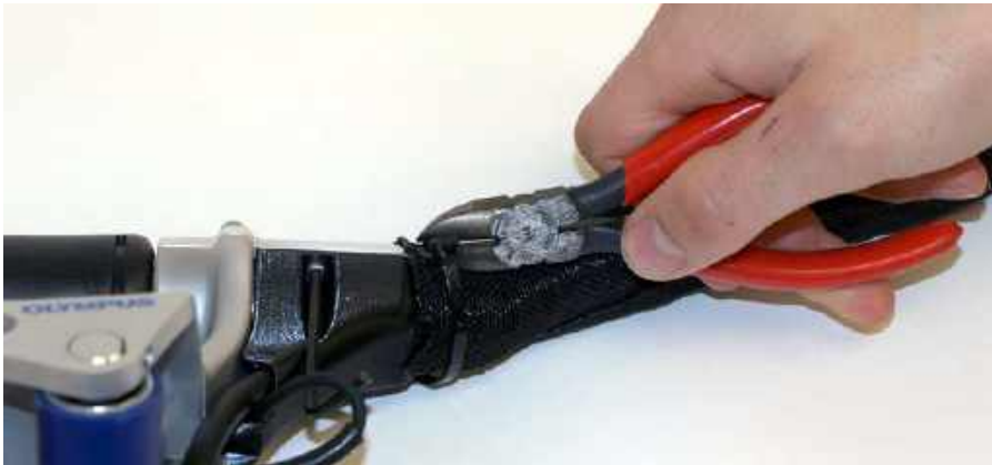
Рис. 6-38 Разрезание кабельной стяжки на рукоятке RollerFORM
