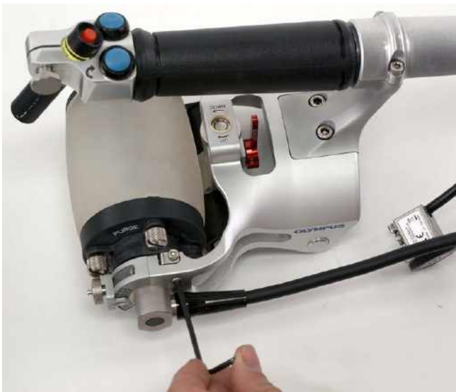
Рис. 6-47 Ослабление винта альтернативного держателя кодировщика
