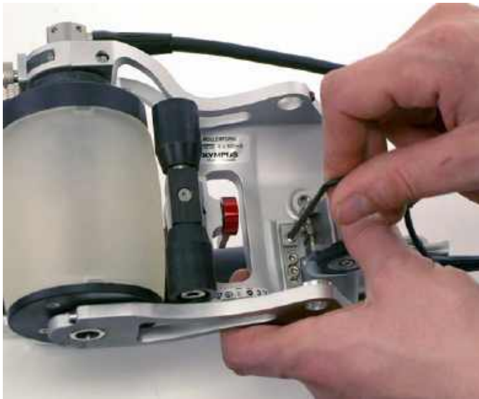
Рис. 6-43 Ослабление крепежного винта кодировщика
