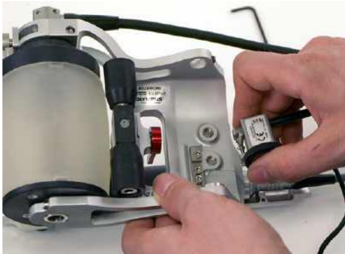
Рис. 6-44 Снятие кодировщика Mini-Wheel
