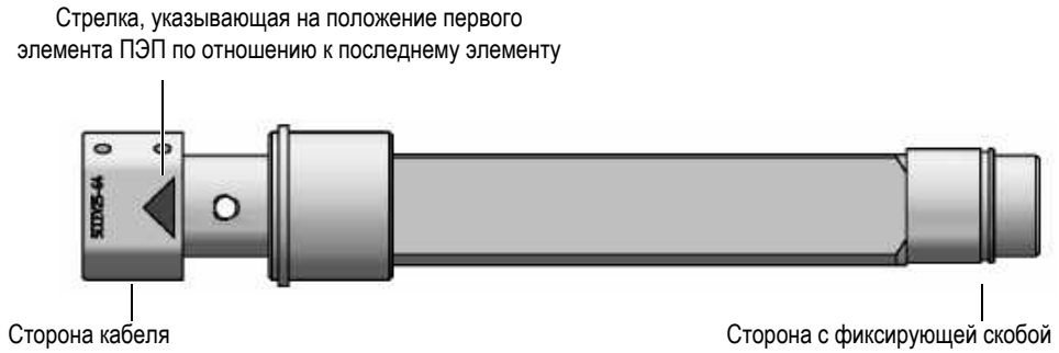
Рис. 5-2 Стрелка на оси-преобразователе указывает направление от первого элемента к последнему
