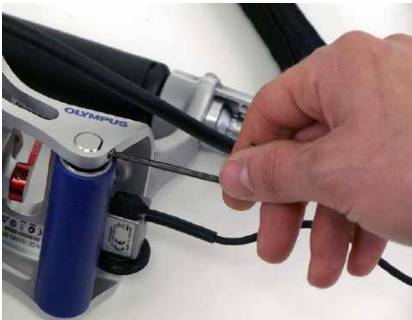
Рис. 6-52 Ослабление крепежного винта заднего ролика
