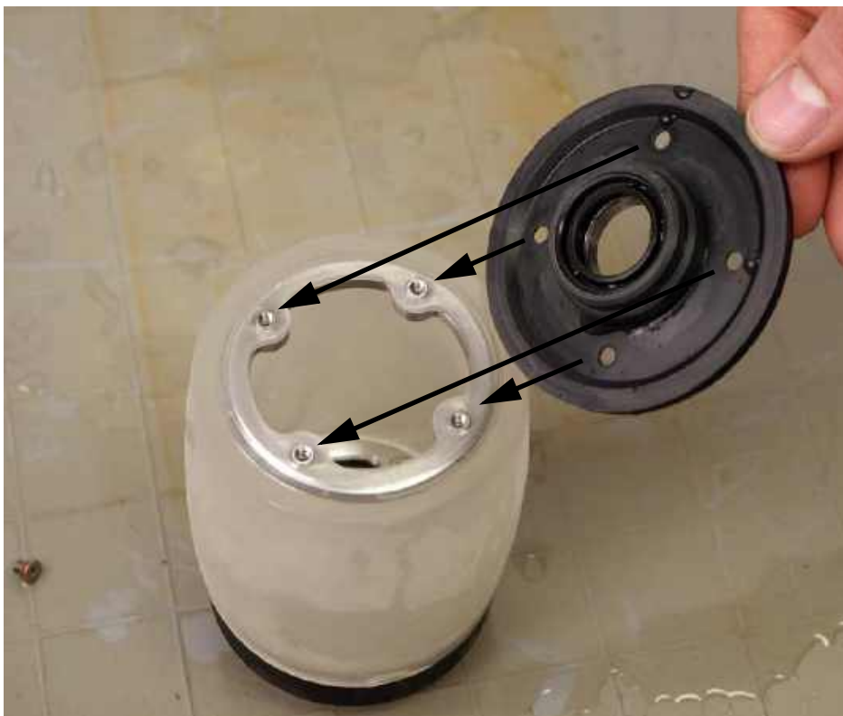
Рис. 6-33 Установка плоского фланца
