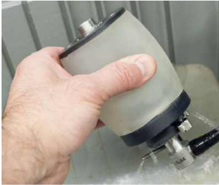
Рис. 6-5 Опорожнение резервуара колеса
