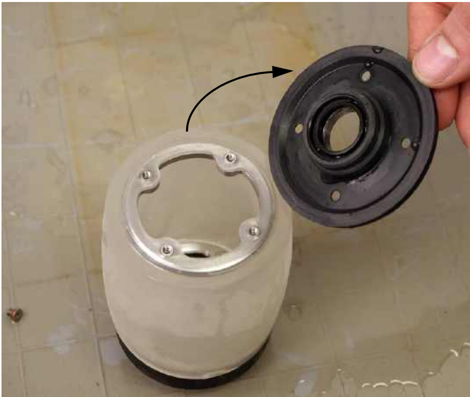
Рис. 6-25 Снятие плоского фланца акустического колеса
