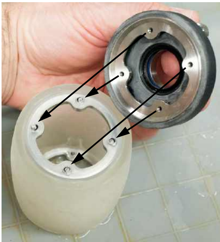
Рис. 6-31 Установка фланца с контрольными клапанами
