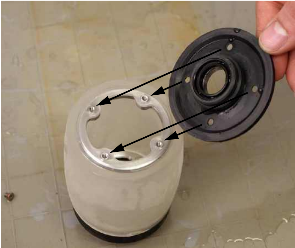
Рис. 6-16 Установка плоского фланца
