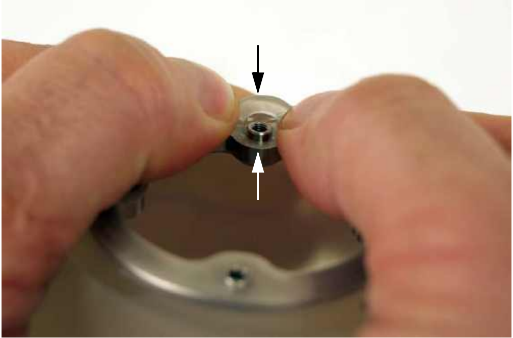
Рис. 6-30 Установка кольца в гнездо шины
