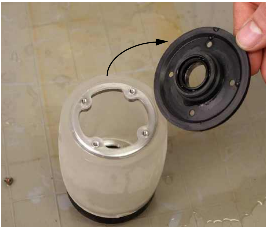
Рис. 6-15 Снятие плоского фланца акустического колеса
