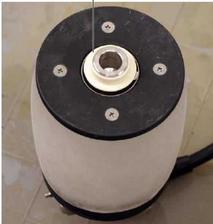
Рис. 6-6 Снятие втулки с оси-преобразователя
