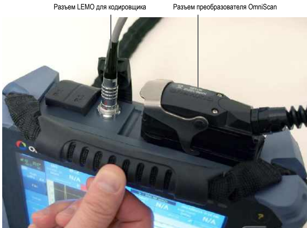
Рис. 2-1 Прибор OmniScan с подключенными кабелями RollerFORM
