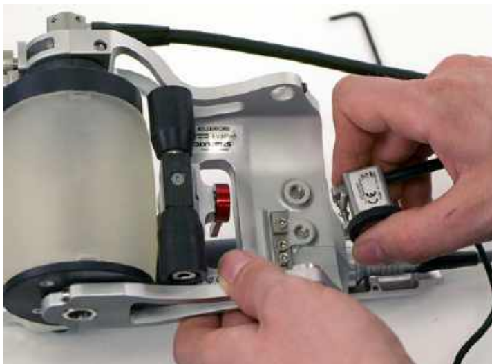
Рис. 6-56 Снятие кодировщика Mini-Wheel
