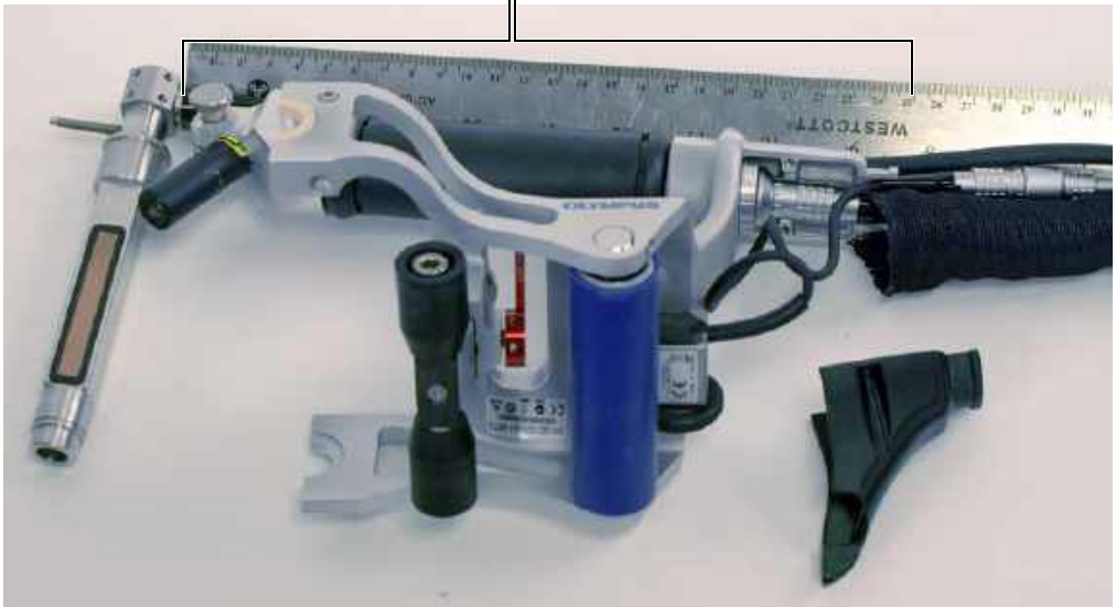
Рис. 6-13 Кабель преобразователя, протянутый вдоль рукоятки RollerFORM
