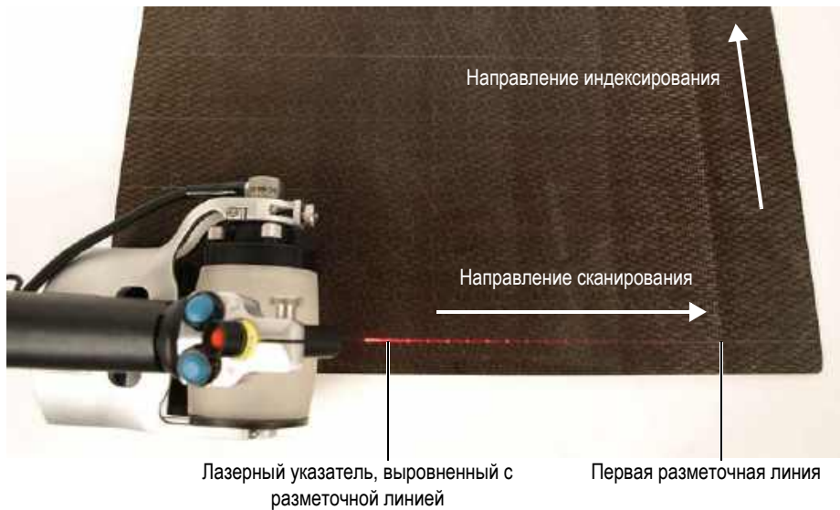
Рис. 5-4 Расположение RollerFORM по первой разметочной линии
