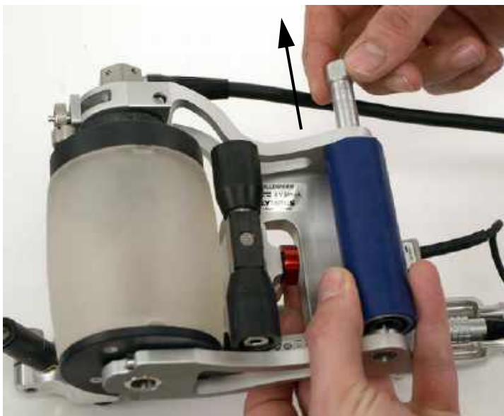
Рис. 6-42 Извлечение оси заднего ролика
