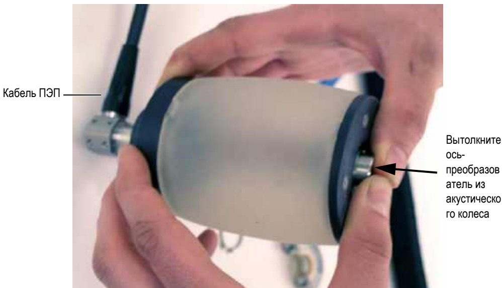
Рис. 6-8 Извлечение оси-преобразователя из акустического колеса
