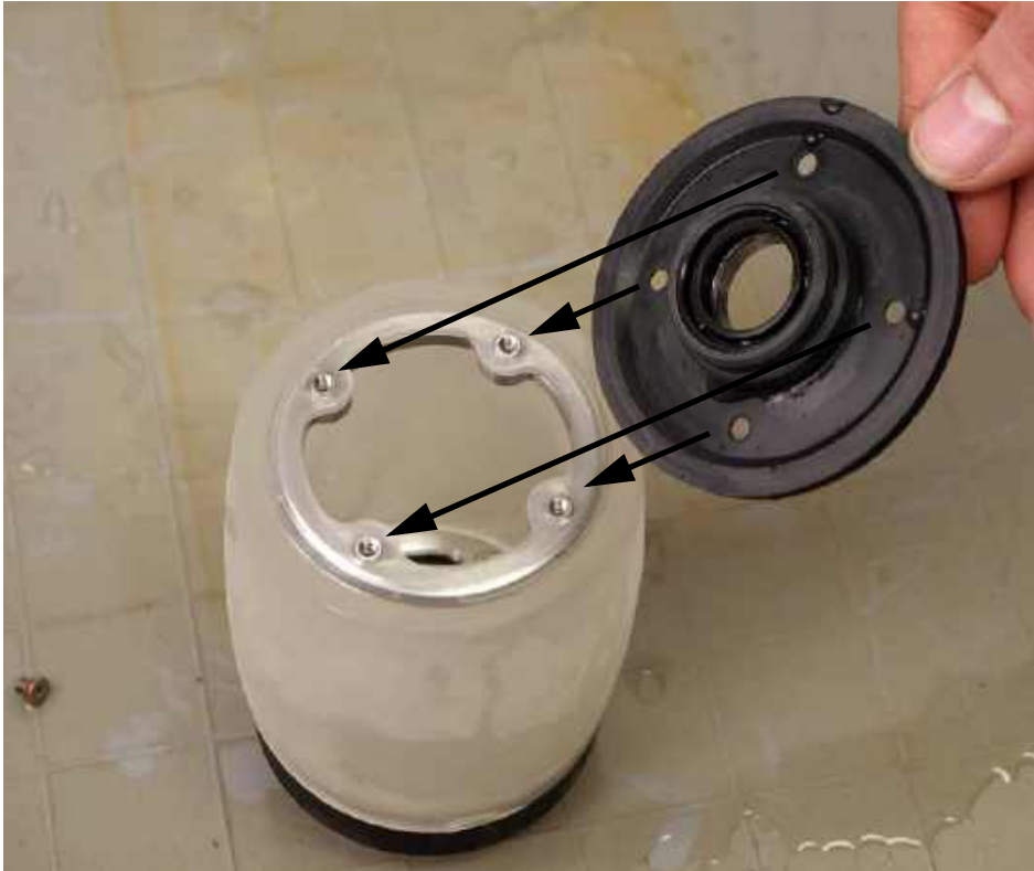
Рис. 6-21 Установка плоского фланца
