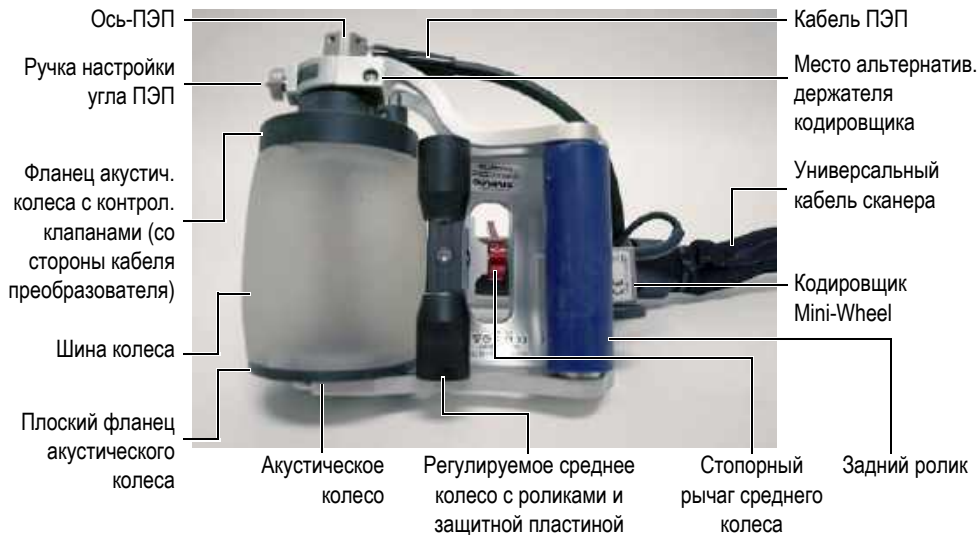
Рис. 1-4 Нижняя часть сканера RollerFORM: три колеса и кодировщик
