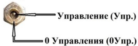
J4 - разъем подключения блока управления тележки АКБ
