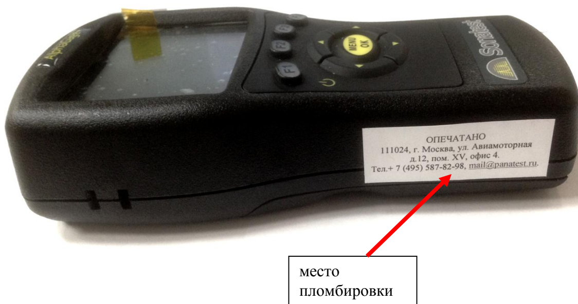
Рисунок 2 – Схема пломбировки от несанкционированного доступа
