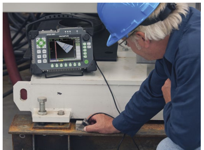
Рейтинг "D" сварного шва по AWS показан для закона фокусировки 45°
