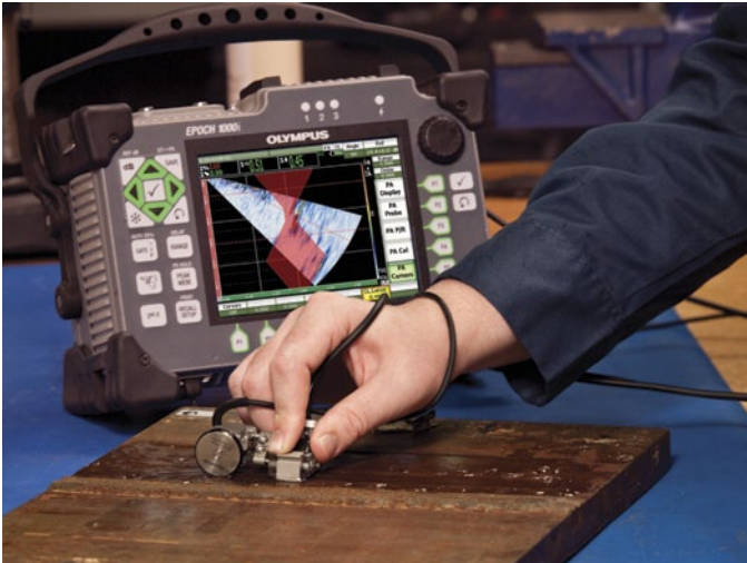
S-скан с отображением профиля сварного шва
