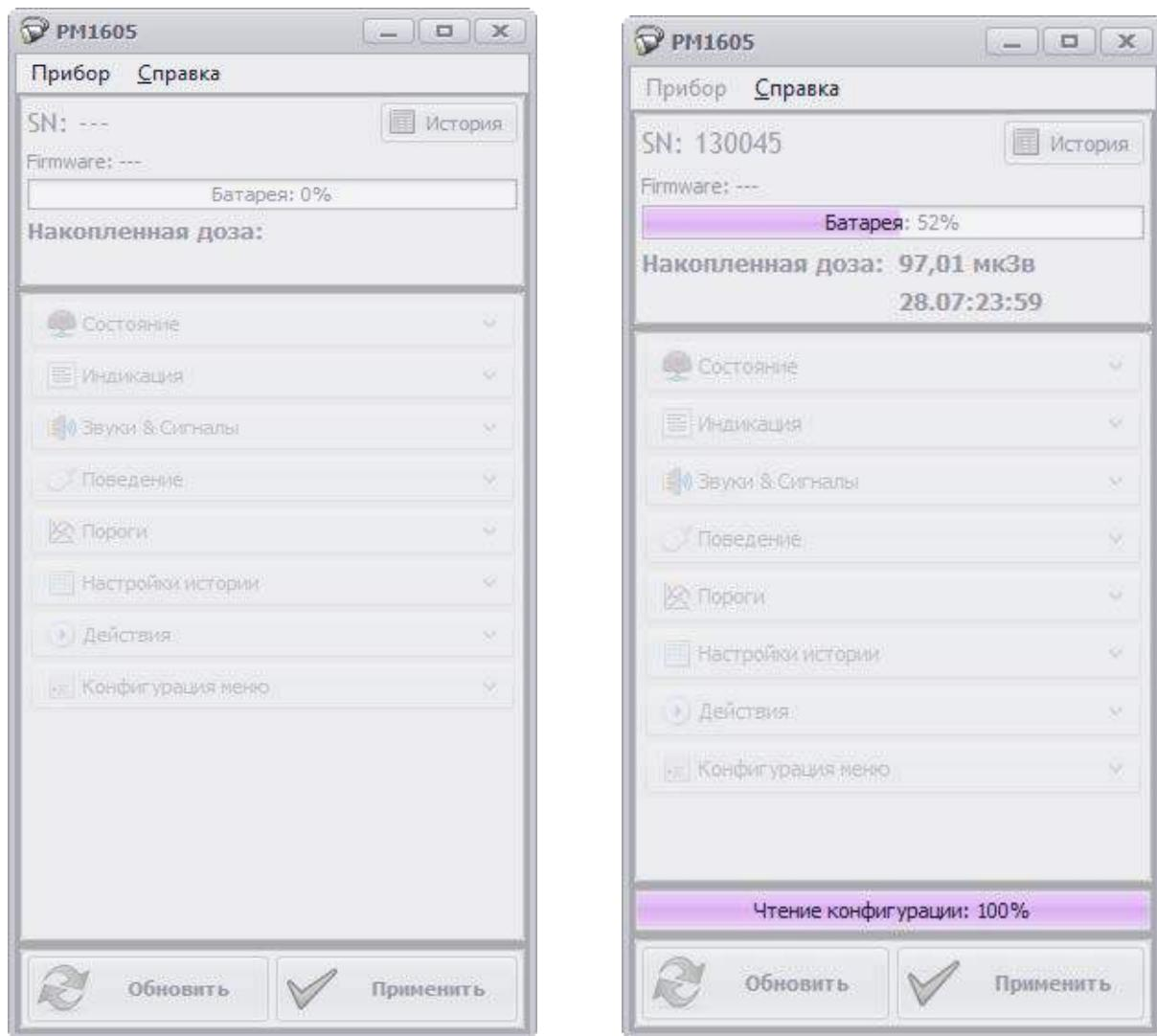
После считывания параметров и установления соединения с прибором главное окно программы станет активным.
