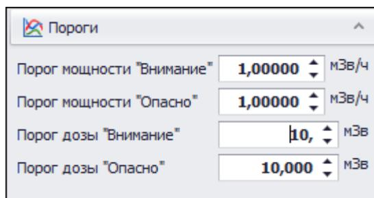
Пороги устанавливаются с помощью вкладки **Пороги** Панели инструментов главного окна программы. Нужно выбрать необходимое значение порогов, пользуясь кнопками регулировки
