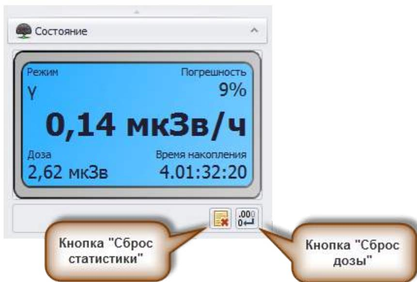
Вкладку **Состояние** можно открыть из меню **Прибор** главного окна программы, выбрав строку **Состояние**, или открыв соответствующую вкладку панели инструментов.
