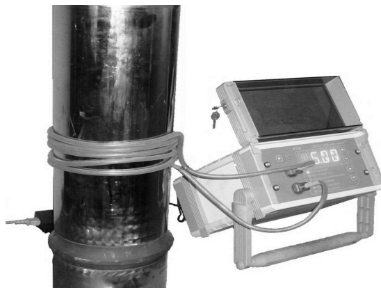
Рис. 1. Внешний вид дефектоскопа МД-М (блок МД-И) с намагничивающим кабелем, подготовленного к контролю стойки основного шасси самолета
