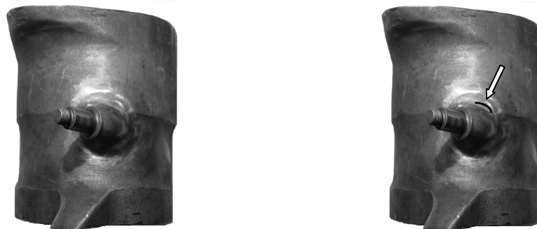
Рис. 3. Внешний вид фрагмента стойки основного шасси самолета Як-40 с усталостной трещиной до и после проведения магнитопорошкового контроля при помощи дефектоскопа МД-М
