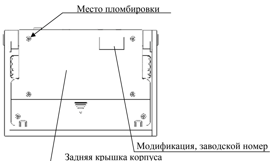
Рисунок 3 - Схема пломбировки корпуса дефектоскопа
