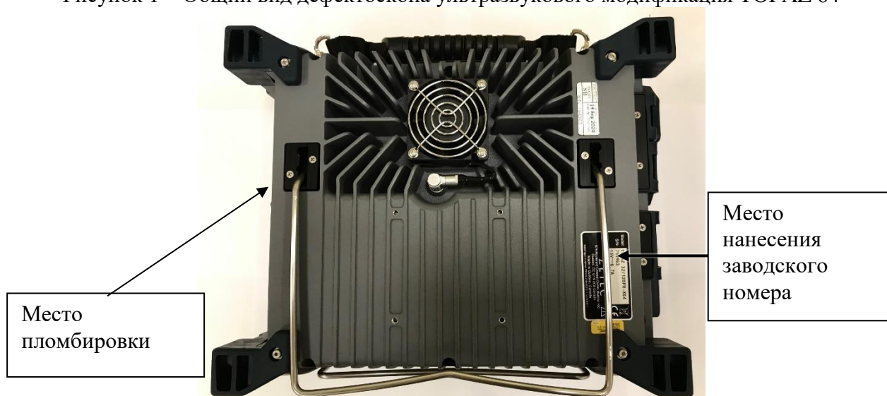
Рисунок 2 – Схема пломбировки и обозначение места нанесения заводского номера
