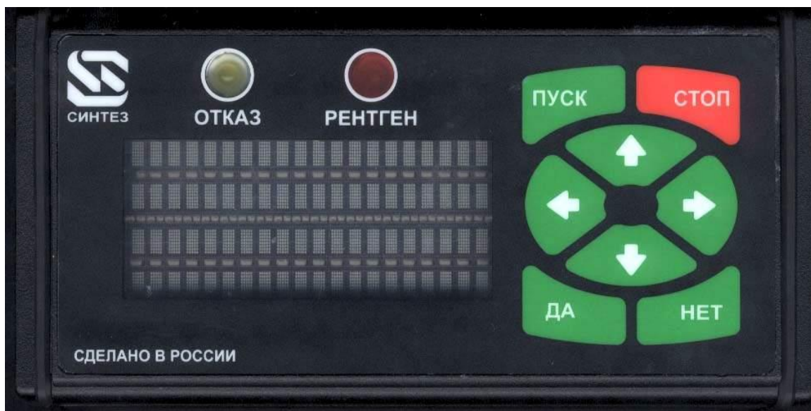
Рис. 2 Лицевая панель пульта дистанционного управления
