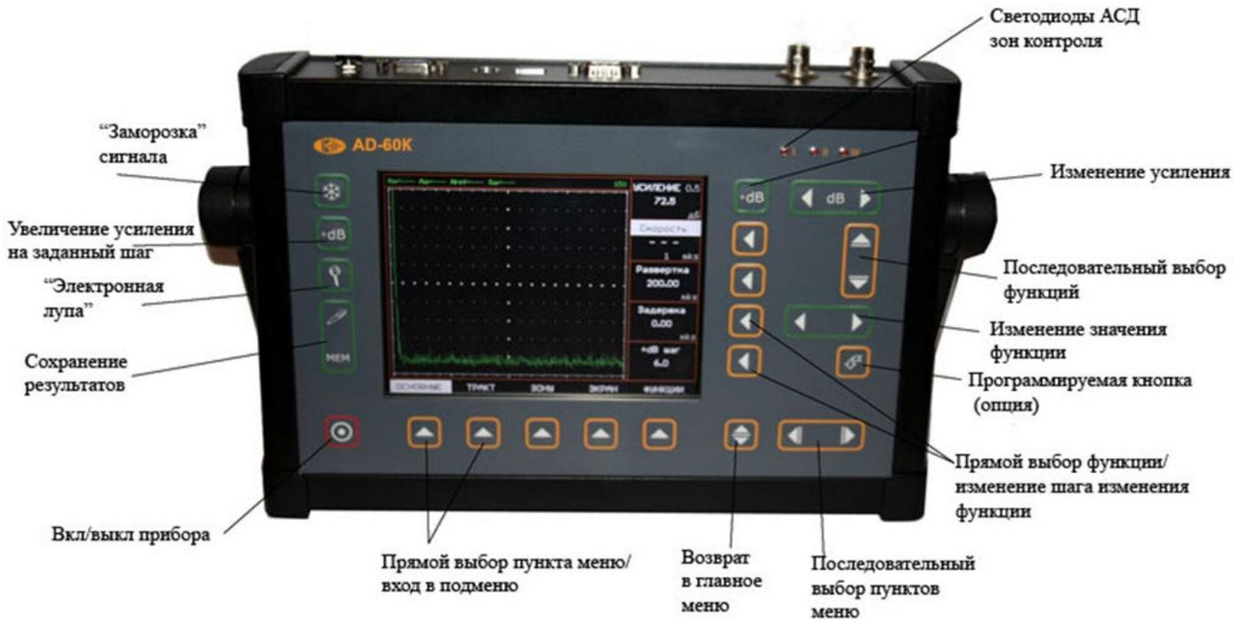
Рис 1-2—Клавиатура дефектоскопа
