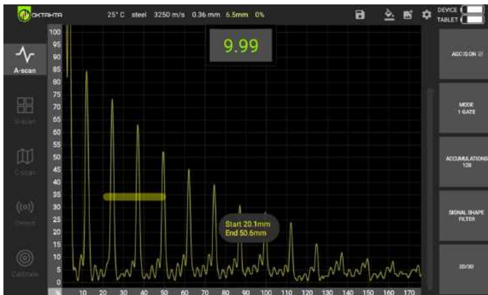
Рисунок 4.9 – Отображение координат найденного максимума в стробе
