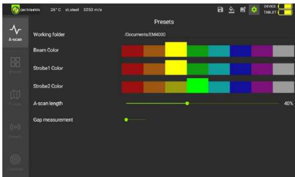
Рисунок 4.15 – Настройка программы и внешнего вида А-скана
