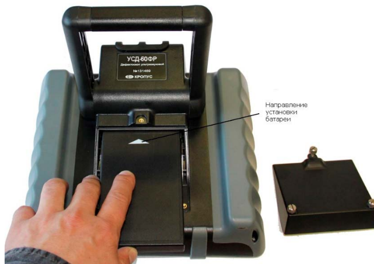
Рис 1-4 Установка нового аккумулятора
