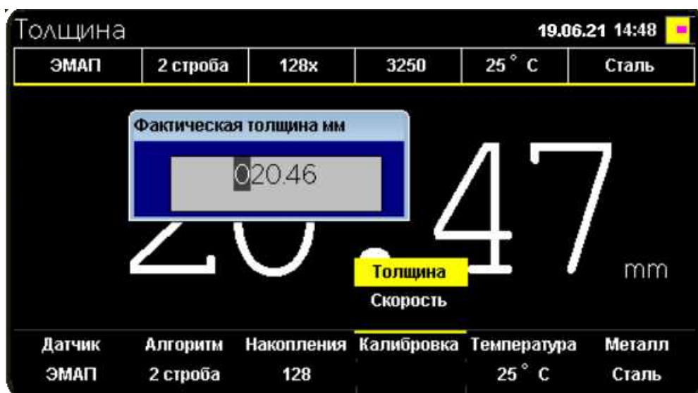
Рисунок 2.5 – Способы калибровки прибора
