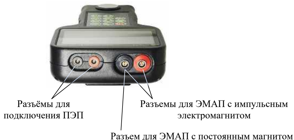
Рисунок 1.2 – Соединители на верхней стороне прибора
