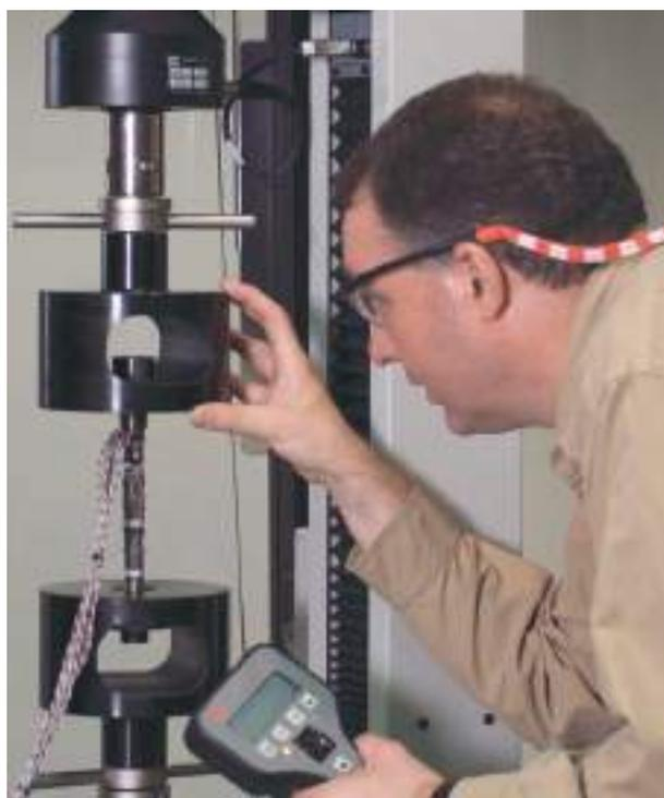
Регулировка силовой рамы
