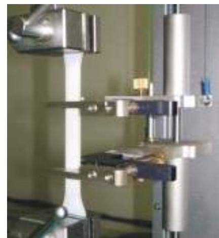
Экстензометр для больших удлинений
