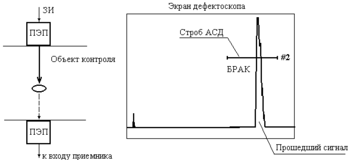
Рис. 4.13.2. Работа автоматического сигнализатора дефектов для теневого метода.
