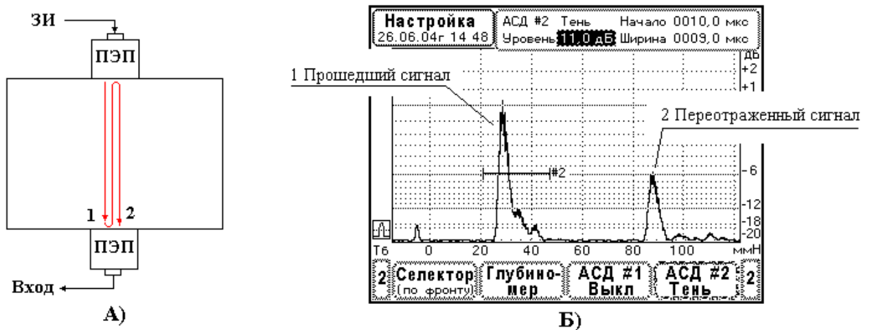
Рис. 9.4.11.2. Настройка строба АСД#2 для контроля листов теньвым методом.
